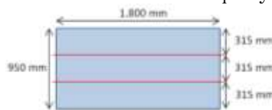
Gambar 7. Dimensi standar bahan baku plat yang disarankan
