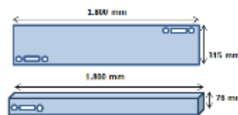
Gambar 4. Plat sebelum dan sesudah bending
