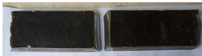
Gambar 6. Spesimen plat 11 mm dibentuk dengan gap 2 mm
