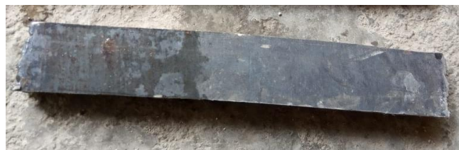
Gambar 5. Spesimen plat 11 mm dipotong dengan ukuran 150mmx30mmx11mm
