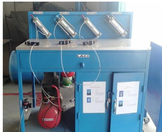
Gambar 4. Alat peraga sistem pneumatik manual
