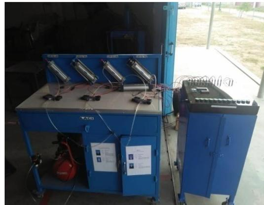
Gambar 6. Alat peraga sistem pneumatik otomatis
