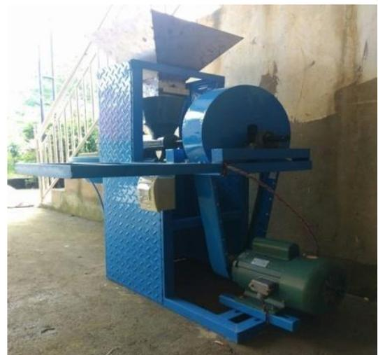
Gambar 2. Mesin penggiling kacang motor listrik
