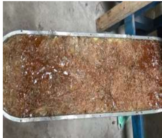
Gambar 3.7 Posisi cetakan dimiringkan untuk pelapisan resin bagian ujung kiri
