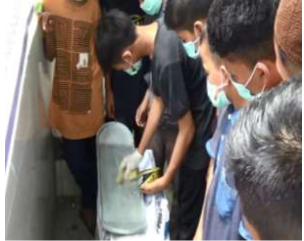
Gambar 3.4 Pelapisan cetakan dengan mould release glaze wax
