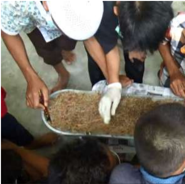
Gambar 3.6 Pelapisan serat sawit pada lapisan resin
