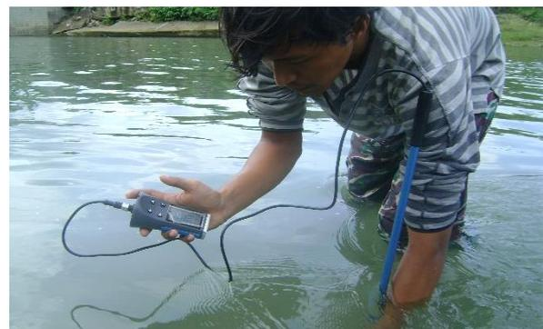
Gambar 4. Pengukuran Kecepatan Air
