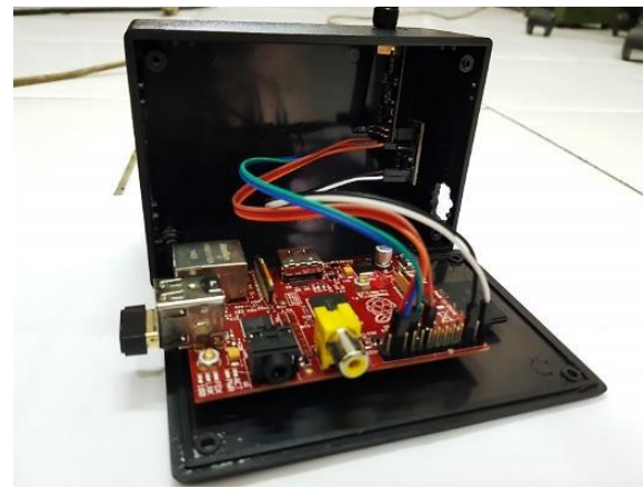
Gambar 7. Alat komunikasi menggunakan jaringan RF
