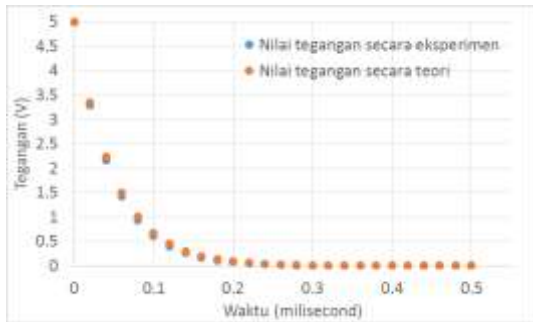
Gambar 10. Kurva perubahan tegangan V_c(t) (kapasitor elektroda plat sejajar berdielektrik udara dengan jarak antar elektroda 2 mm dan resistor 125 megaOhm)
