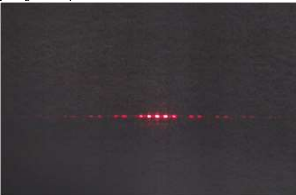
Gambar 2 Hasil eksperimen pola interferensi tiga celah
