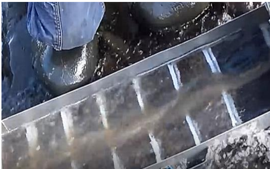
Gambar .Penggunaan Sluice box
