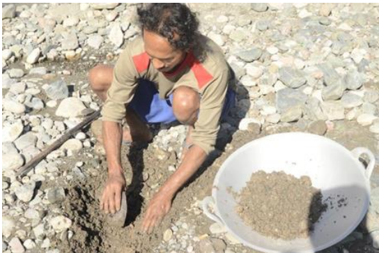
Gambar 1. Menggali pasir yang mengandung emas placer
