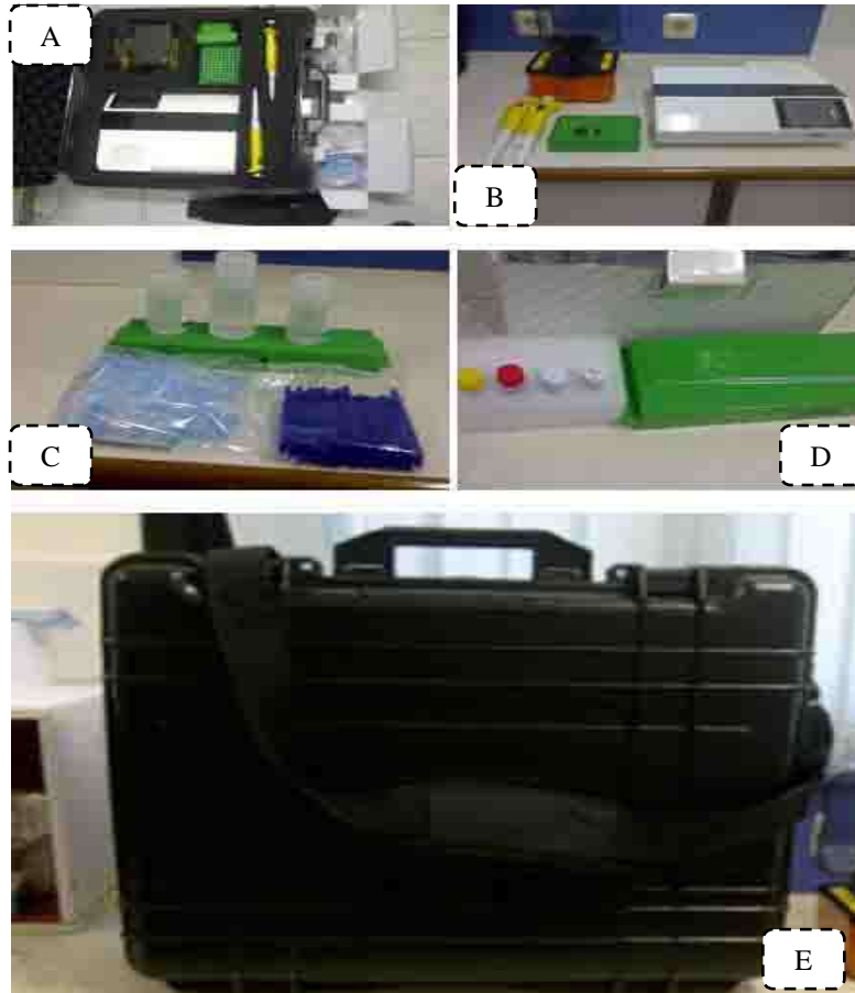
Gambar 2. Perlengkapan Pockit Nucleic Acid Analyzer Portabel-PCR Berupa Mesin PCR, Mikro Pipet dan Alat Spin Down (A dan B), Paket Reagensia Ekstraksi dan Amplifikasi (C dan D) yang Dikemas dalam Satu Koper Kecil yang Siap Dibawa untuk Pengecekan di Lapangan (E) 7
