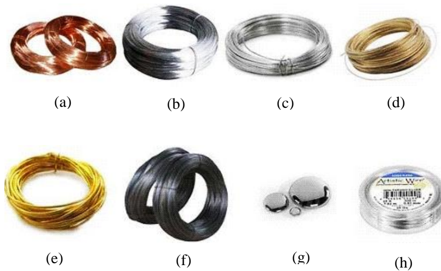
Gambar 4. Bahan-Bahan Konduktor (a) tembaga, (b) besi, (c) aluminium, (d) kuningan, (e) emas, (f) baja, (g) raksa/mercury, dan (h) perak. (Sumber: http://elkatechno.blogspot.com )
