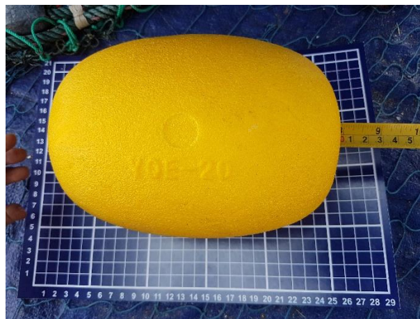
Gambar 9. Pelampung pada Purse Seine Cakalang (Sumber: Penelitian, 2019)
