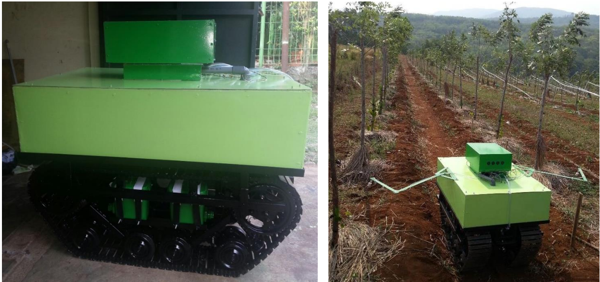
Gambar 2. Model robot fertigasi lada yang sedang dikembangkan di Balittro. Foto: Pitono et al (2018)
