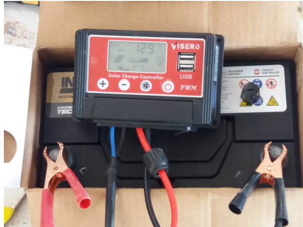
Gambar 6 Pengukuran Tegangan Pada Controller
