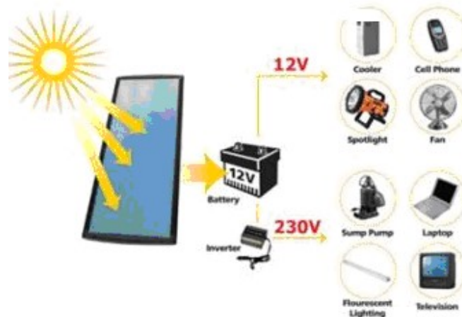
Gambar 3 Prinsip Kerja Listrik Tenaga Surya ( http://solarsuryaindonesia.com/tenaga-surya )
