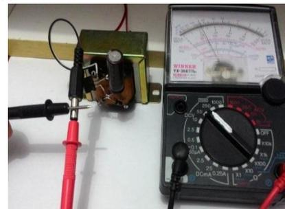
Gambar 5.4 Pengujian Catu Daya
