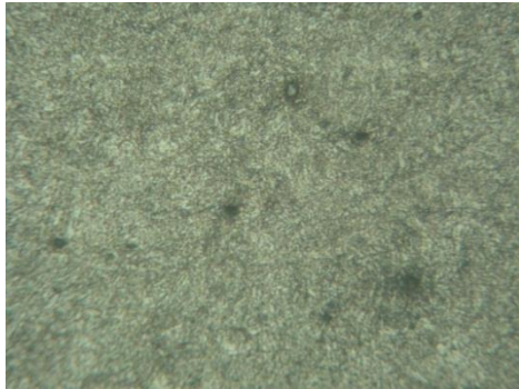
Gambar 4.17. Struktur mikro setelah ditemper temperatur 400°C lama penahanan 2 jam pembesaran 500x
