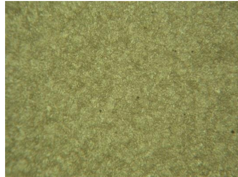
Gambar 4.20. Struktur mikro setelah ditemper temperatur 600°C lama penahanan 2 jam pembesaran 200x
