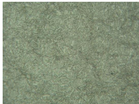
Gambar 4.21. Struktur mikro setelah ditemper temperatur 60°C0 lama penahanan 2 jam pembesaran 500x.
