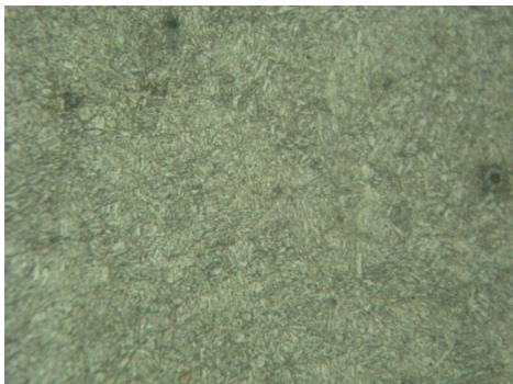
Gambar 4.19. Struktur mikro setelah ditemper temperatur 500°C lama penahanan 2 jam pembesaran 500x
