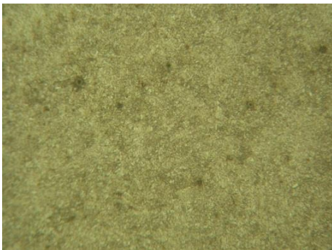
Gambar 4.18. Struktur mikro setelah ditemper temperatur 500°C lama penahanan 2 jam pembesaran 200x
