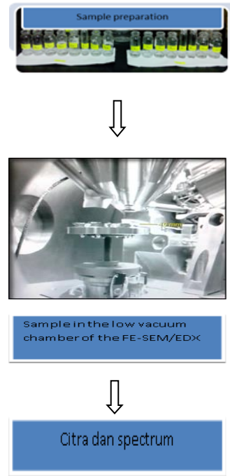
Gambar 1 Flow Metode Jalannya Penelitian Dari Data Citra Dan Spektrum Mikroskop Elektron
