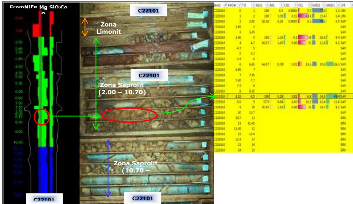
Gambar 9. Generalisir soft material sebagai domain saprolit bercampur dengan boulder yang belum mengalami proses pelapukan secara sempurna.
