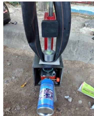
Gambar 16. Proses kerja alat tambal ban
