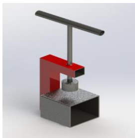
Gambar 3. Alat tambal ban desain dengan Solidwork
