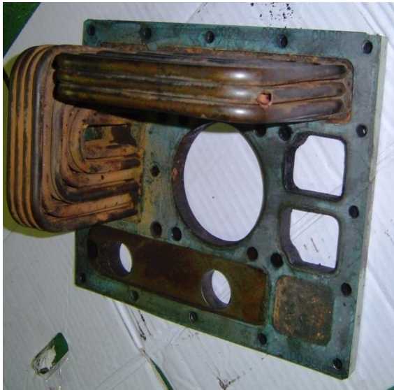
Foto 1. Pipa pipa intercooler berlubang
