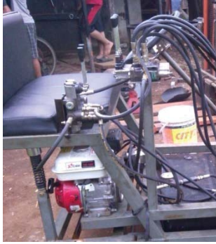
Gambar 2. Gambar hasil perakitan komponen hydraulic dan mesin bensin dalam rangka
