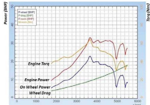
Gambar 5: Tenagakeluaranmesin Toyota 4K padaperbandingankompresi 13:1 denganinjeksi air
