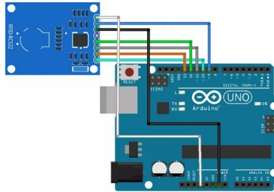
Gambar 5. Module Arduino Dengan Pembaca RFID
