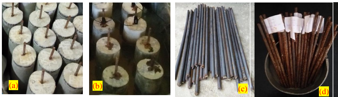
Gambar 4 Perubahan Pada Permukaan Beton (a. Sebelum Pengujian, b. Setelah pengujian) korosi Baja Tulangan (c. Sebelum Pengujian, d. Setelah pengujian)
