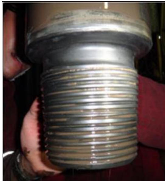
Gambar 2 Kerusakan Ulir pada HWDP
