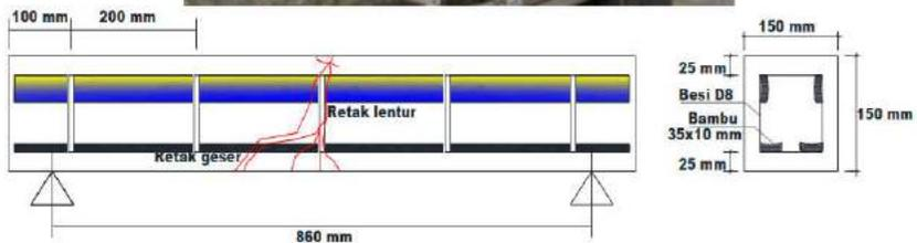
Gambar 8. Pola retak balok tipe 2
