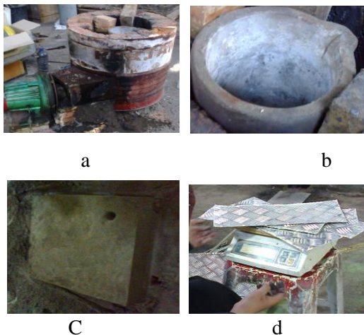
Gambar 1. a) tungku peleburan Al; b) kowi 5 Kg; c) cetakan pasir; d) penimbangan skrap
