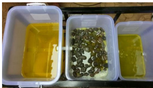
Gambar 3. Proses Adsorpsi pada Prototipe IPAL Elektroplating
