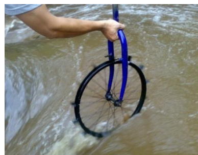
Gambar 3. Pengambilan kecepatan aliran sungai dengan kincir untuk data debit
