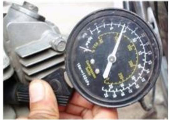
Gambar 9. Hasil Test Kompresi Motor Modifikasi
