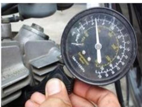
Gambar 8. Hasil Test Kompresi Motor Standar
