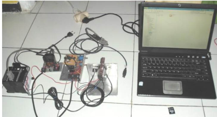
Gambar 9 Rangkaian keseluruhan yang terintegrasi dengan laptop
