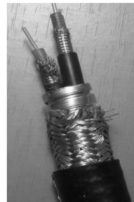
Gambar 7. Struktur kabel penghubung detektor menuju pre-Amp.
