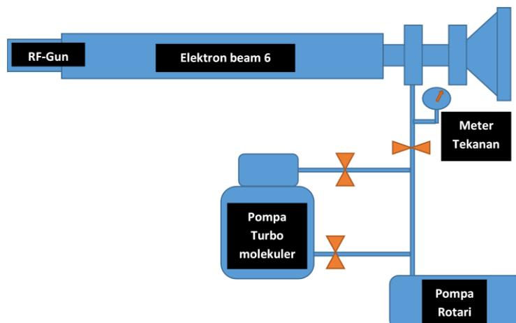
Gambar 3. Blok skema sistem vakum untuk AEET.
