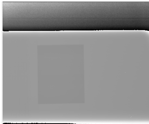
Gambar 9.b. Citra radiografi dengan mengaktifkan gain calibration
