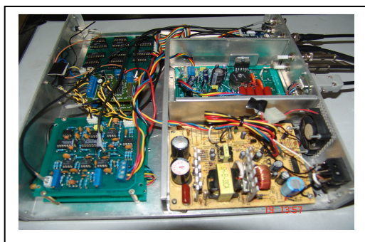
Gambar 4. Instalasi Modul Elektronik Renograf IR8
