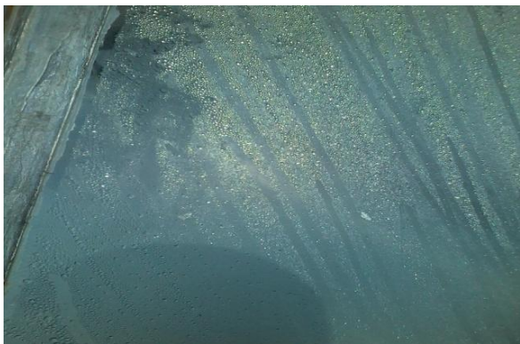
Gambar 4. Bulir-bulir air hasil evaporasi pada dinding piramida.
