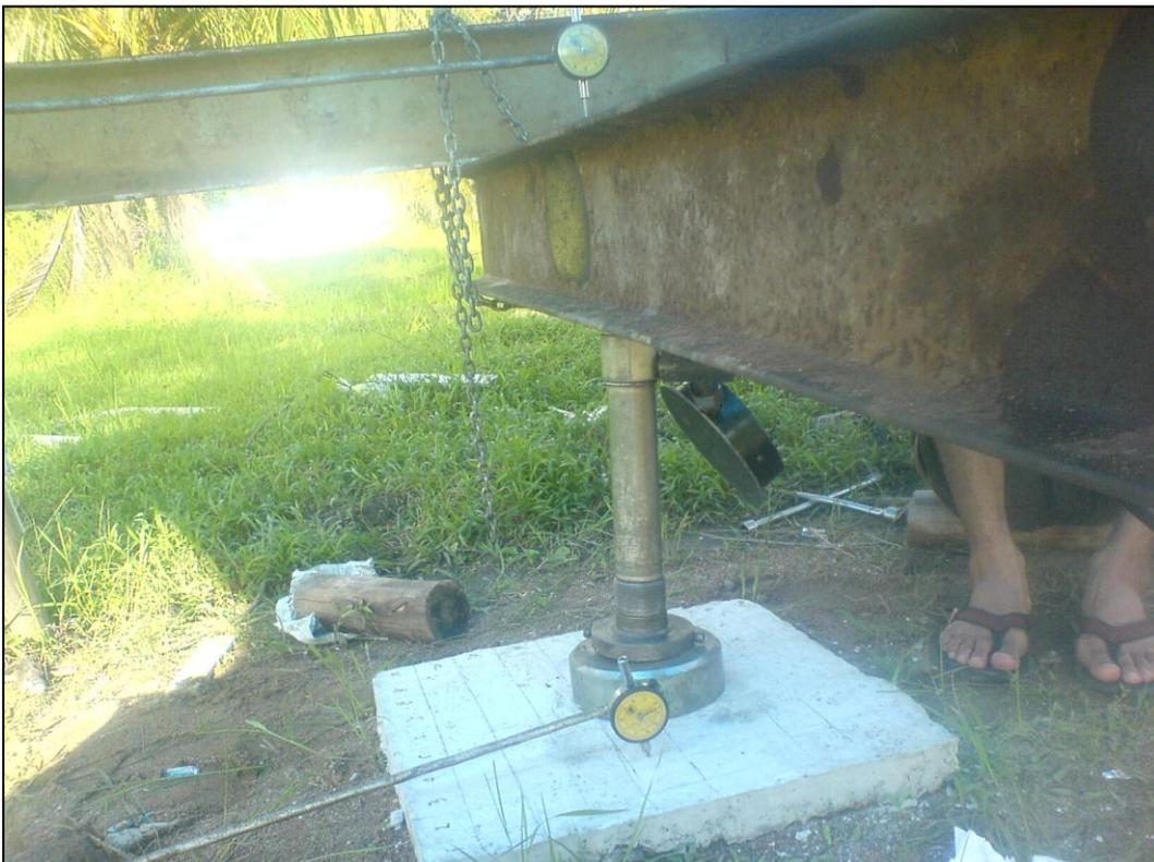
Gambar 4 Sistem pembebanan
