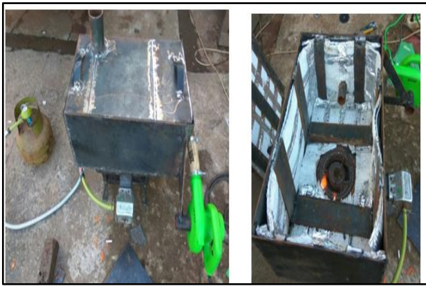
Gambar 3. Percobaan Tungku Pemanas Hasil Desain
