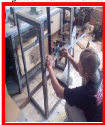
Gambar 4. Mengukur Letak Bearing
