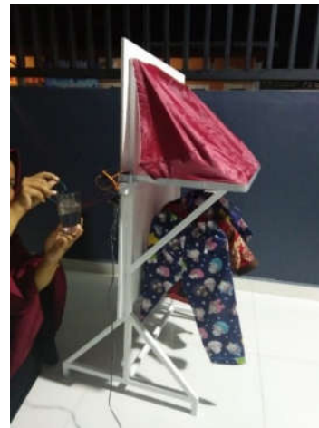
Gambar.6 Sensor Air Diberi Tetesan Air
