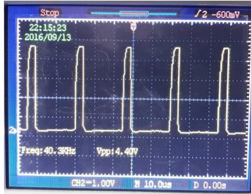
Gambar 13 Pengujian komparator
