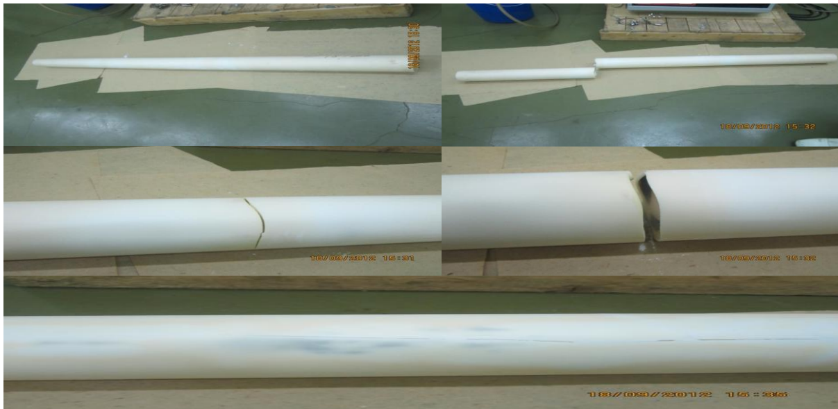
Gambar 8. Keretakan/patah pada tabung alumina.
