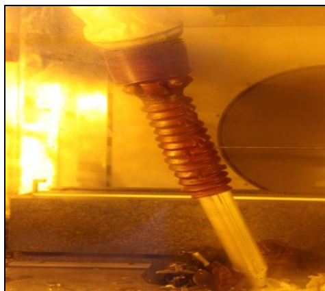
Gambar 1. Kondisi manipulator dengan kerusakan pada mekanisme gerakan naik-turun slave arm dan booting
