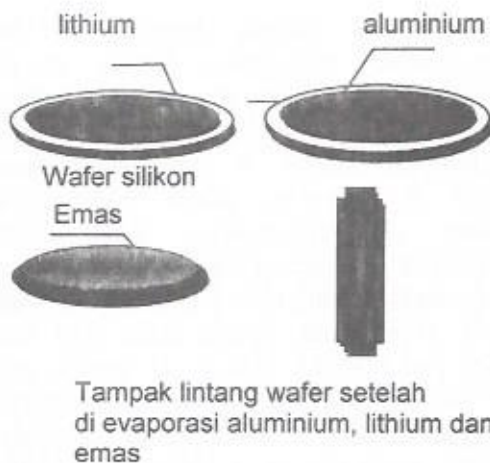
Gambar 6. Tampak hasil evaporasi pada kedua sisi permukaan silikon wafer
