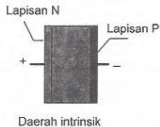
Gambar 4. Lapisan Intrinsik yang terjadi pada solid state semikonduktor
