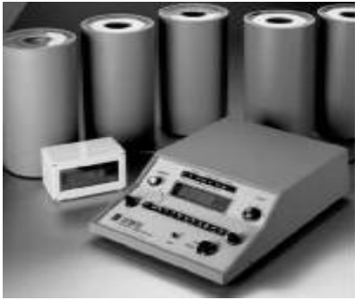
Gambar 2. Kamar Ionisasi Gamma (Capintec CRC-712M)
