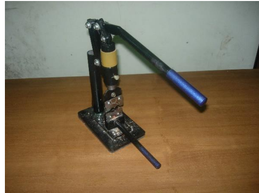
Gambar 1. Hasil rancang bangun “Mesin Pengupas Mete”.
