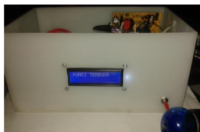
Gambar 7. Bentuk alat kendali perangkat elektronik dengan menggunakan identifikasi suara berbasis smartphone
