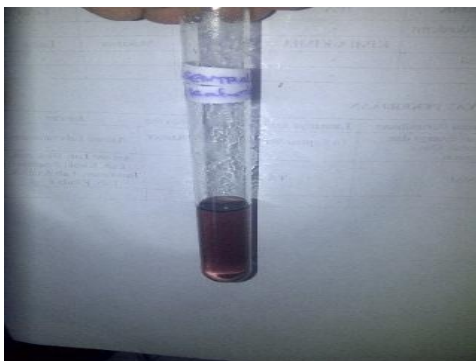
Gambar 1. Hasil Positif Berwarna Ungu (menunjukkan adanya kandungan formalin pada sampel ikan asin)
