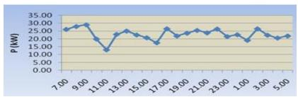
Gambar 8. Grafik Profil Energi Listrik Pada ID Fan
