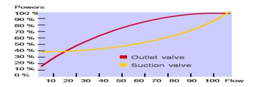
Gambar 1. Karakteristik kecepatan terhadap daya pada sistem valve (throttle)
