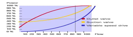
Gambar 2 Karakteristik kecepatan terhadap daya dengan throttle dan VSD
